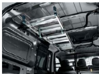
983 - nosilci za prevoz dolgih predmetov v tovornem prostoru
